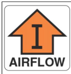
オレンジ色の「I」記号は、吸気FRUを表しています。このユニットは、装置のノンポート側から吸気し、ポート側に排気します。この記号は、部品番号に「NPI」が付いたFRUに付けられます。
